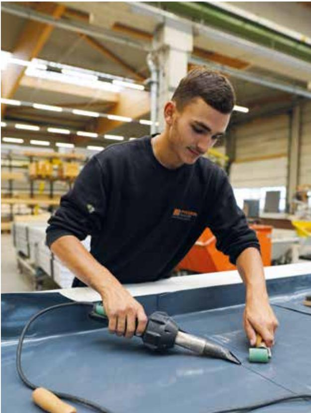
Flachdächer werden in der Produktion vorgefertigt und sicher verschweißt.
